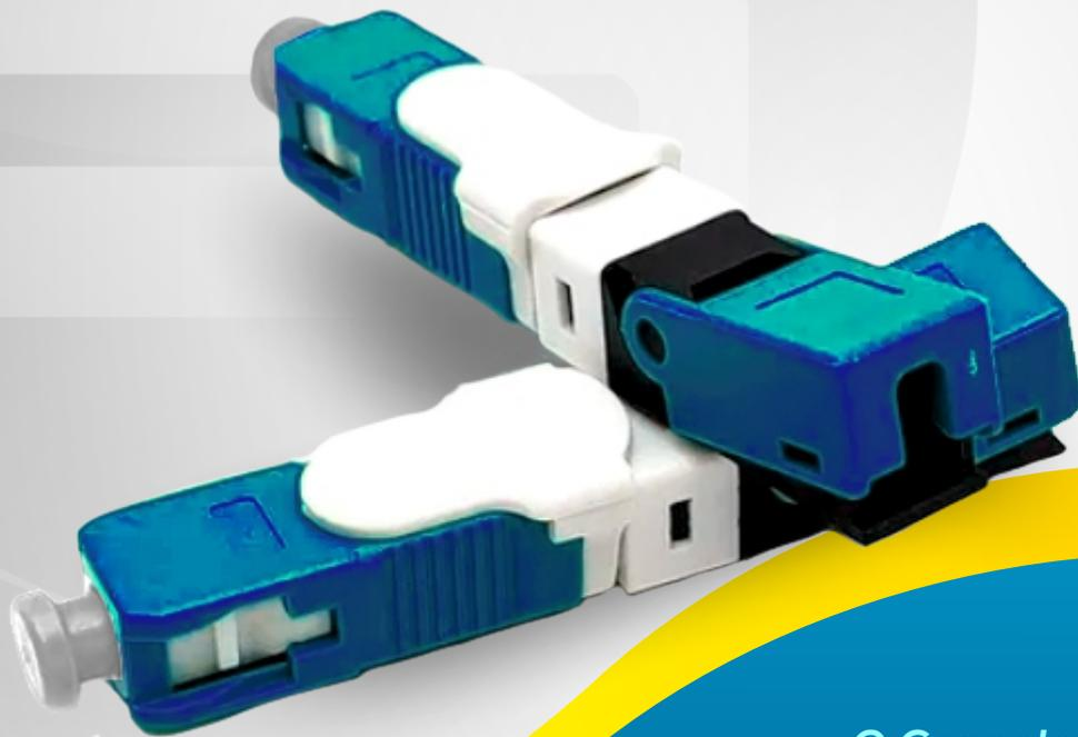
O Conector Fast Click é um conector de campo manual e foi projetado para cabos Drop Flat de até 3mm de espessura ou cordões ópticos de 2mm a 3mm, pode ser reutilizado por até 5 vezes. Indicado para atendimento de clientes em redes FTTH. Fabricado com padrão SC e polimento UPC
